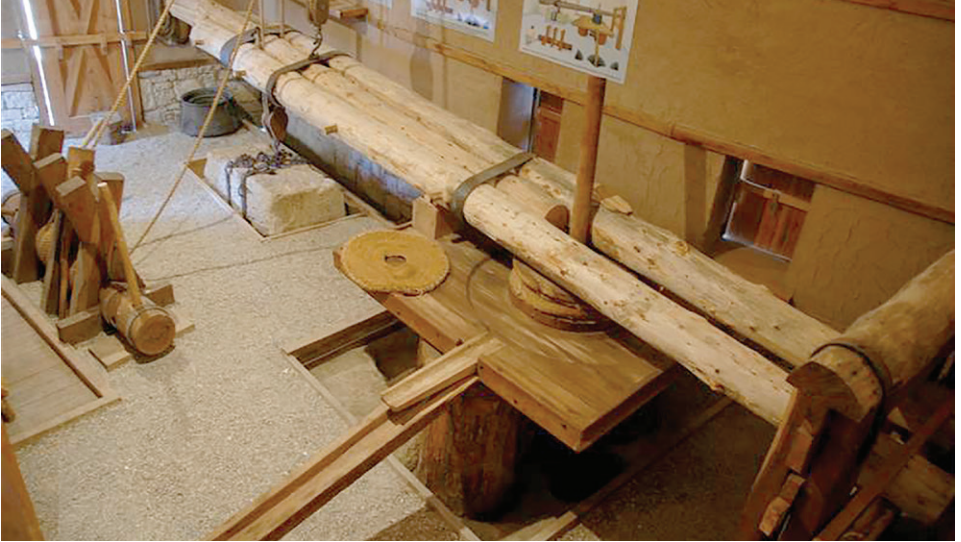
Baskı Sistemi (Bocurgat, pres tablası, pres kolu)
