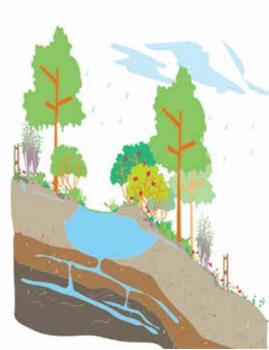
Şekil 10: Hendekler: Eğim boyunca yüzey akışını tutarak toprağa su sızdırmak ve toprak tutucu, erozyonu önleyici bitki örtüsünün gelişmesini sağlamak için yapılır.
