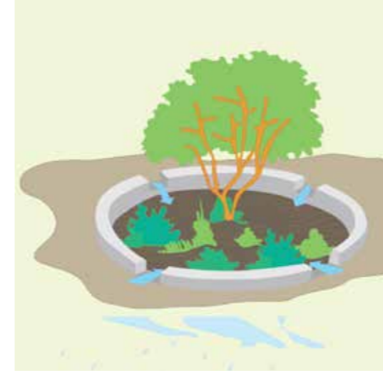
Şekil 11: Süzdürme Çanakları: Bu sistemler yağmur suyunu alır, biriktirir ve süzer; yollardan da yüzey akışını topladığı ve bitkilerle birlikte toprağa yedirdiği için sel kontrolü sağlar.
